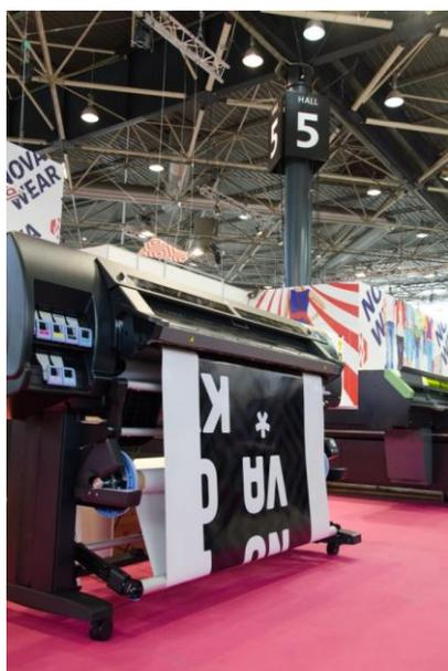
L'impression roll-to-roll permet d'imprimer des supports en rouleaux. La machine à encres Latex (vue sur l'espace Nova Live) est une solution polyvalente qui permet d'imprimer tout type de supports souples : textile, vinyle, papier, PVC...
